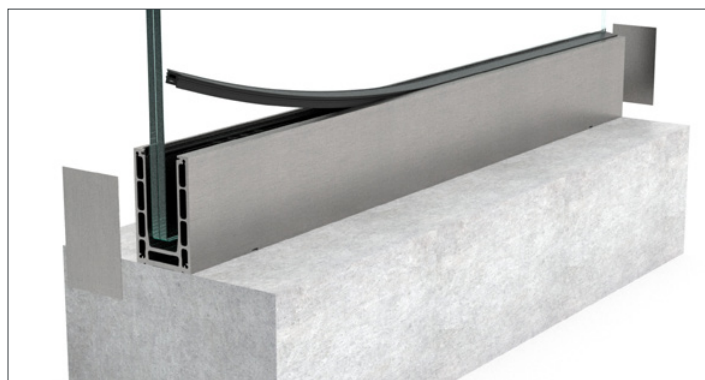
6. Pres det sidste gummi på plads og afslut med at montere ende kappe.
