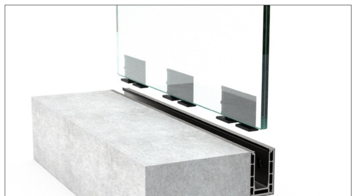
4. Placere plastvinkler derefter løft glas på plads, 3 pr. mtr.
